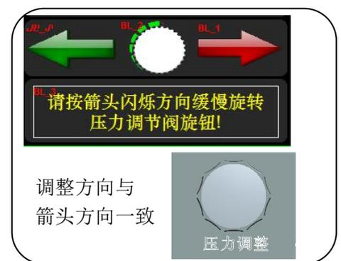
按闪动红色箭头指示方向旋动右侧压力调节旋钮，至箭头变绿。
